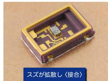
[純スズ箔を挟んだ <IC パッケージと銅板> の接合]
