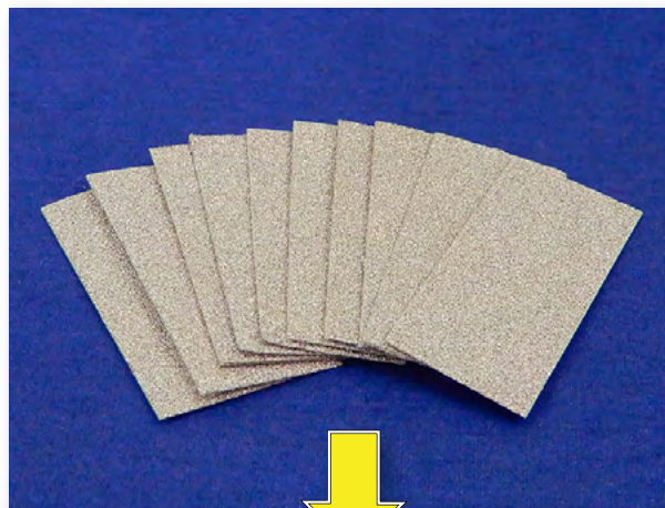
発泡ニッケル積層シート の2カ所同時接合
