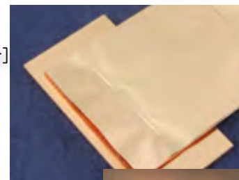
[銅積層箔と銅プレート の2カ所同時接合]
