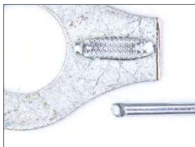
アルミ線 : φ 1.0mm 引張り強度 : 57N ＜母材切れ＞
