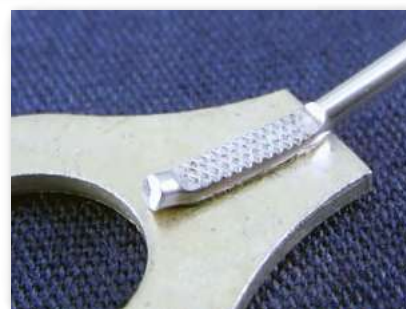
音波接合後の スズめっき銅端子と Al 線
