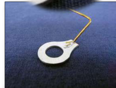
スズめっき銅端子と φ 0.85 mm Al 被膜線
