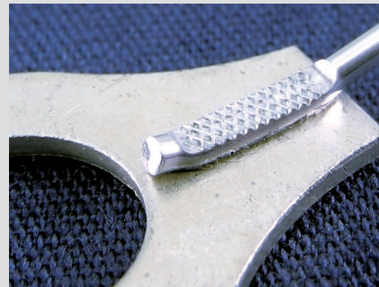
音波接合後のスズめっき銅端子とAl線
