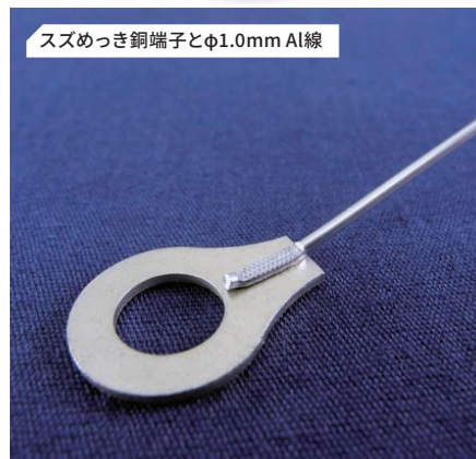
スズめっき銅端子とφ0.85mm Al被膜線
