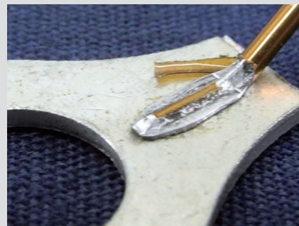
音波接合後のスズめっき銅端子とAl被膜線
