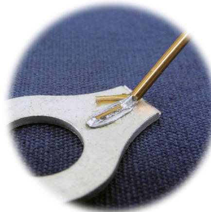
スズめっき銅端子とφ0.85mm Al被膜線
