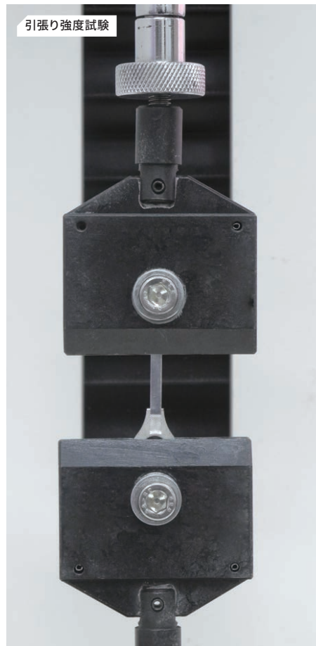
アルミ線 : φ1.0mm 引張り強度 : 57N 母材切れ
