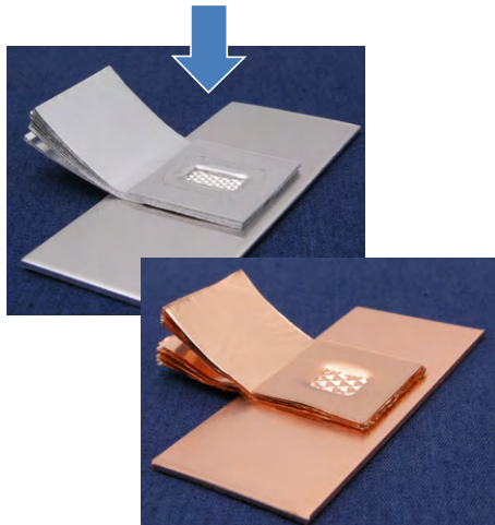
[コンタミが発生しない (アルミ箔や銅箔) の綺麗な多層同時直接接合]
