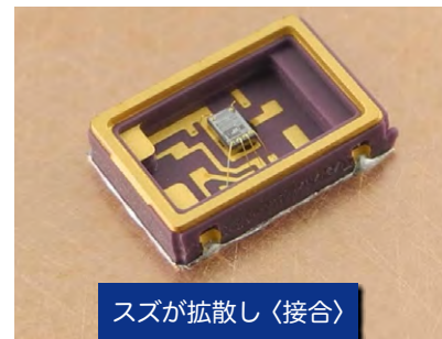
[純スズ箔を挟んだ (ICパッケージと銅板) の接合]
