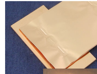
【銅積層箔と銅プレートの2カ所個別接合】
