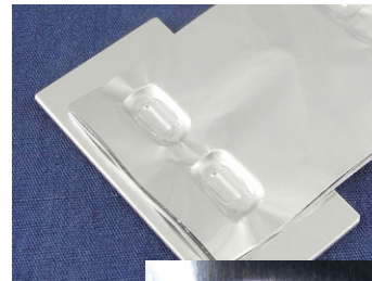
【アルミ積層箔とアルミプレートの2カ所個別接合】
